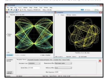
Option VM07 PDC, ( $\pi$ /4 DQPSK, 21 kS/s, 800 MHz, 0 dBm), RMS EVM: 0.6%
